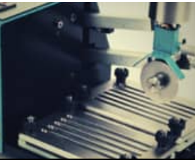
Machine pour la résistance à la coupe (Ancienne EN388) - Lame rotative
